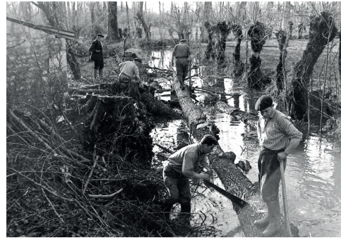
Les troncs ébranchés sont mis à l'eau et préparés pour constituer le train de bois.
